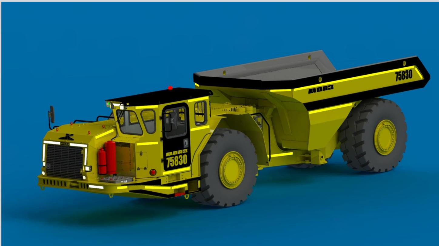
Предназначен для транспортирования и самосвальной разгрузки горной массы и полезных ископаемых в подземных условиях не опасных по пыли и газу, а также вне автомобильных дорог общего пользования в условиях открытой добычи.
