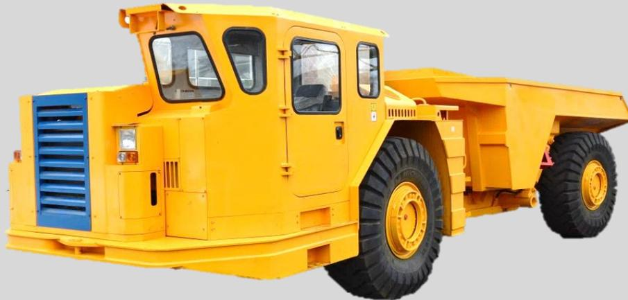
Предназначен для транспортирования и самосвальной разгрузки горной массы и полезных ископаемых в подземных условиях не опасных по пыли и газу, а также вне автомобильных дорог общего пользования в условиях открытой добычи.
