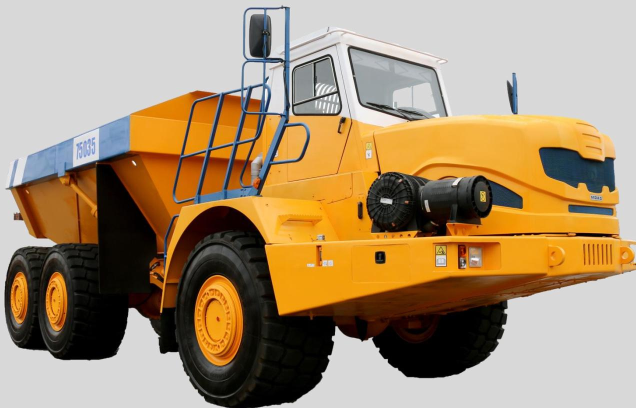
Шарнирно–сочлененный самосвал MoAZ–75035 г/п 50т. предназначен для транспортирования грунта и сыпучих материалов мелких фракций на строительстве гидротехнических сооружений, шоссейных и железных дорог, при производстве вскрышных и рекультивационных работ в горнорудной промышленности и промышленности строительных материалов, в тяжелых дорожных условиях, где отсутствуют подготовленные дороги с твердым покрытием.
