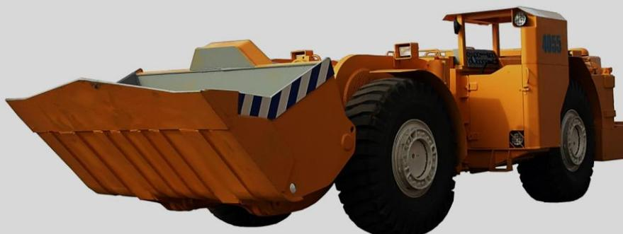
Предназначена для погрузочно-доставочных работ с взорванными или разрыхленными механическим способом породами в стесненных условиях подземных шахт и проходах, не опасных по пыли и газу, а также – в условиях открытой добычи полезных ископаемых, строительстве тоннелей и др.
